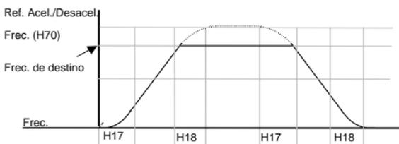
Nota: si la frec. de destino se programa a un valor inferior al de frec. máx., la curva no se visualizará completamente.
