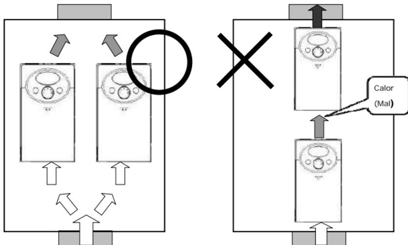
Nota: compruebe que la ventilación sea correcta cuando instale dentro de un panel dos o más variadores o un ventilador de refrigeración.
