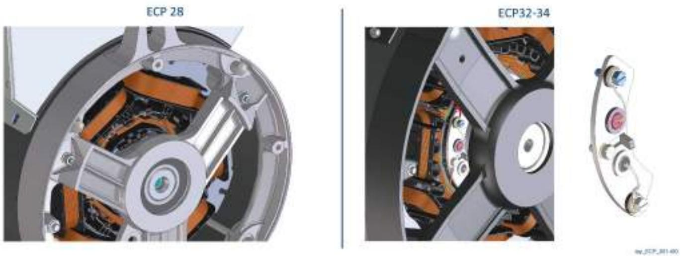
Los alternadores de la serie ECP montan diodos tipo botón, montados directamente en el soporte del diodo excitador (serie 28), o montados en un puente de diodos extraíble (T30), divididos en tres sectores (series 32-34).
