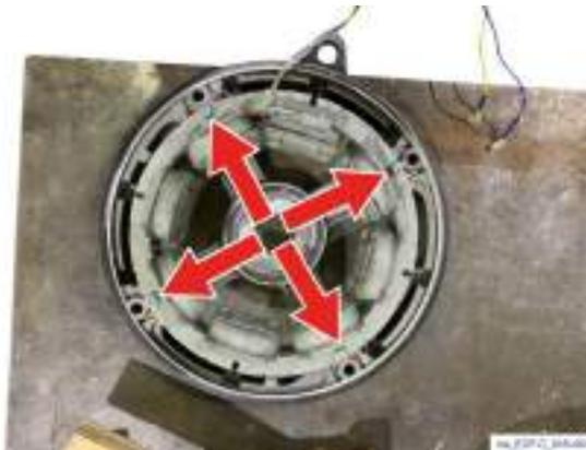
1) Coloque un nuevo estator excitador en los pies de la cubierta posterior con los cables amarillo-azul colocados correctamente hacia la parte superior de la cubierta (vea la imagen al costado), luego empuje el estator en contacto con la ayuda de un martillo de goma. Inserte los tornillos y apriételos a 20 Nm.
