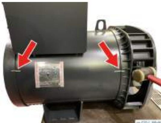
4) Retire la cubierta frontal con la ayuda de un martillo de goma. Observe en la imagen lateral que la alineación entre las cubiertas y la carcasa se marcó previamente con un marcador.
