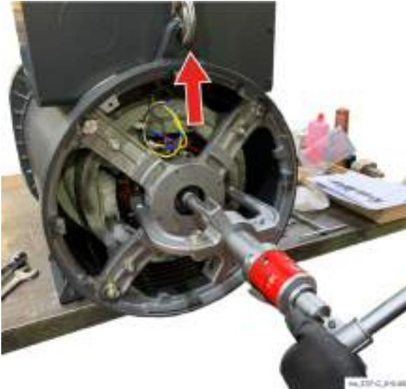
5) Asegure la cubierta posterior a un sistema de elevación adecuado, inserte un tornillo en el orificio trasero del eje y, con un extractor, empuje el eje hasta que el rodamiento haya salido completamente de su asiento en la cubierta posterior.
