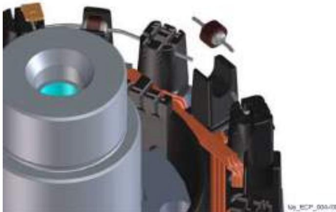
Si los valores encontrados indican un diodo dañado, el componente debe ser reemplazado. Para este propósito, se recomienda no extraer los cables de sus respectivos asientos, sino cortarlos cerca del cuerpo del componente; inserte el nuevo componente respetando las polaridades y suelde cuidadosamente los cables con las piezas que quedan en sus asientos.
