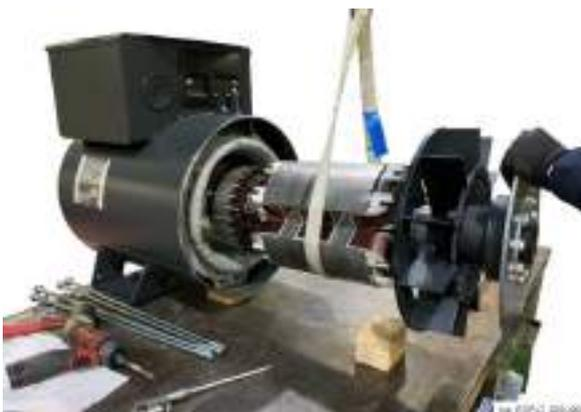
5) Levante el rotor con una correa mordiba, luego insértelo en el estator y empújelo hasta que los paquetes de hojas del estator y del rotor estén alineados.
