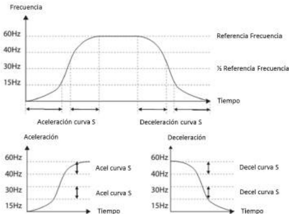
[Configuración patrón Aceleración/Deceleración Curva S]
