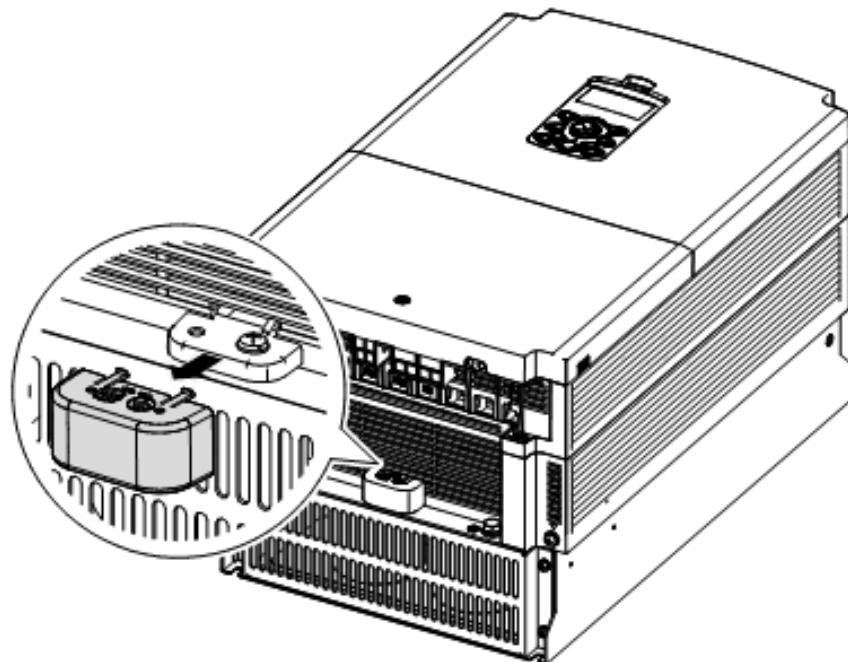
2. Retire el cable de tierra del EMC del borne derecho (Filtro de EMC-ON/valor de fábrica), y conectarlo al borne izquierdo (Filtro de EMC-OFF / para fuentes de alimentación con conexión a tierra asimétrica).
