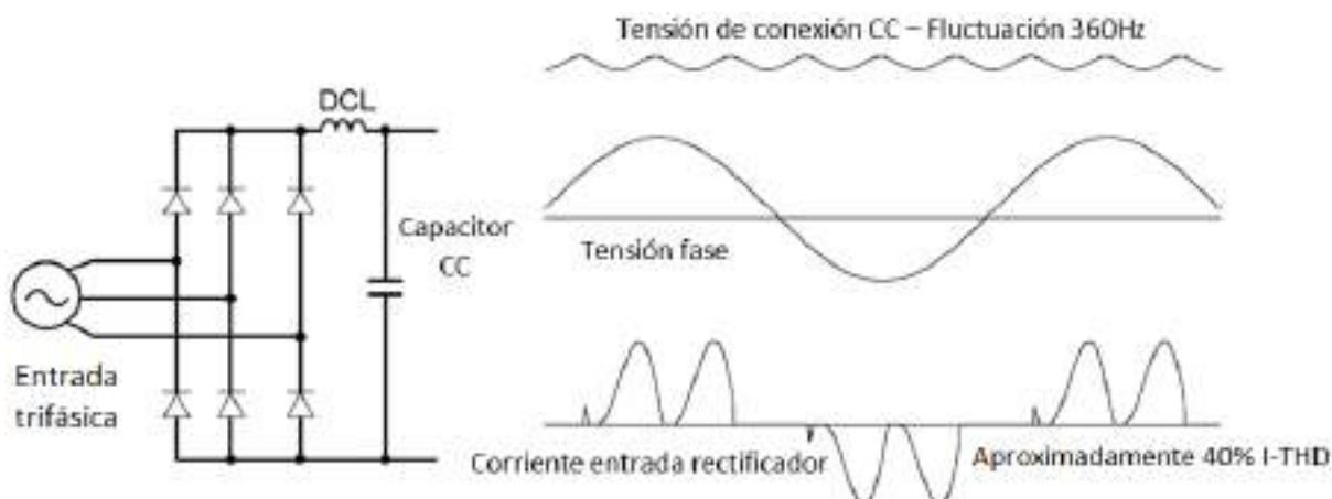
Figura 1 – Configuración Trifásica Típica
