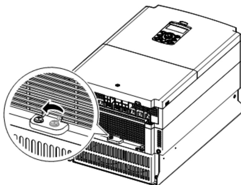
Si se requiere el filtro de EMC en el futuro, invierta los pasos y conecte el cable de tierra del EMC al borne derecho para activar el filtro de EMC.
