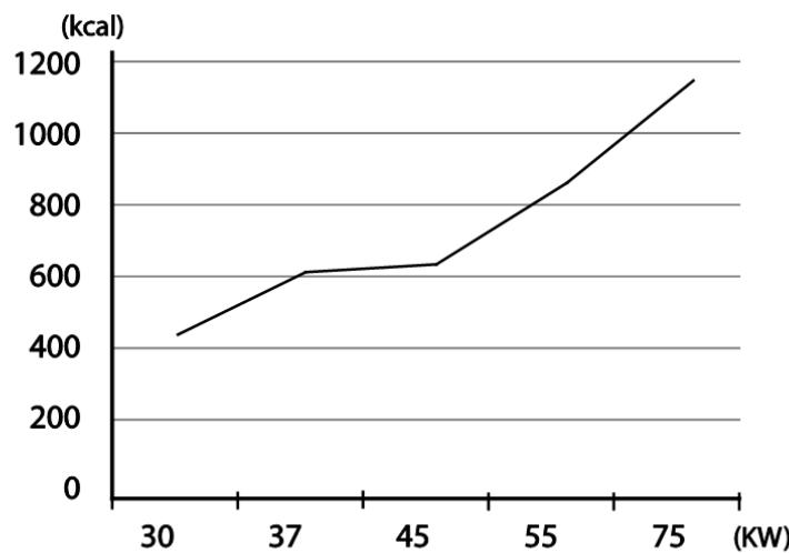
Los datos de emisión de calor se basan en operaciones con valores de la frecuencia portadora predeterminada, en condiciones normales de funcionamiento. Para obtener información detallada sobre la frecuencia portadora, consulte la sección [5.16. Configuración del Ruido de Operación \(configuración de frecuencia portadora\)](#) en la página [173](#).
